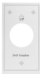
Sisetelefoni paneeli puurimisšabloon (1 tk)
